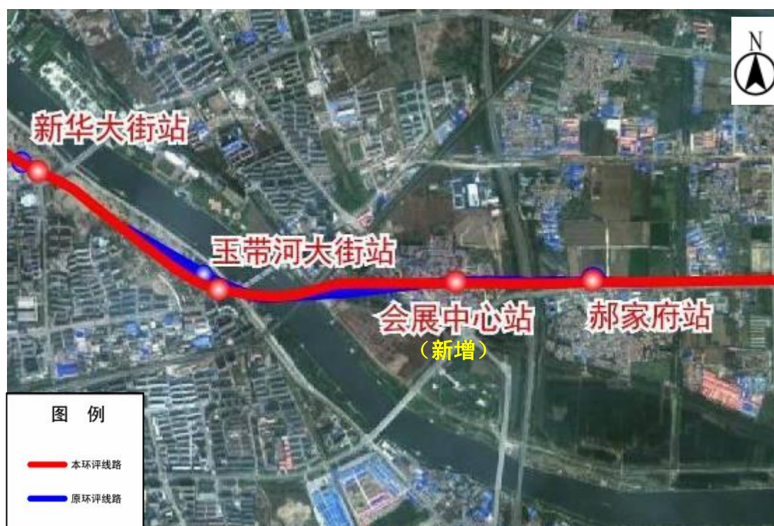
图 2.2-3 玉带河大街站前后区间段线路变化示意图
