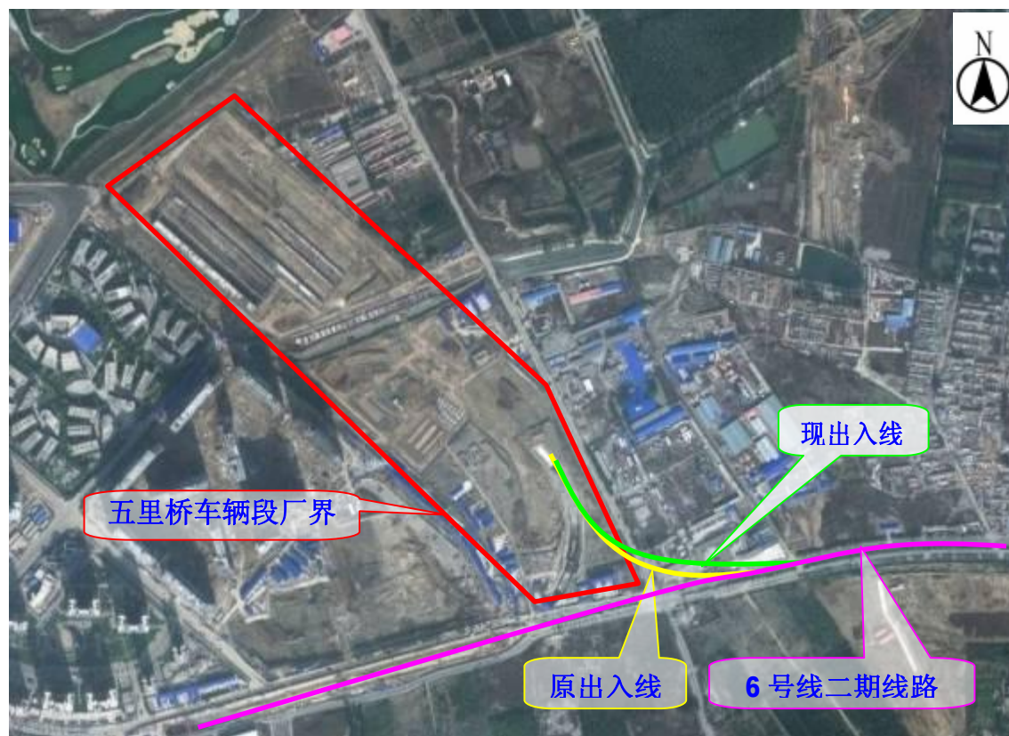
图 2.2-7 五里桥第三条出入段线路变化示意图
