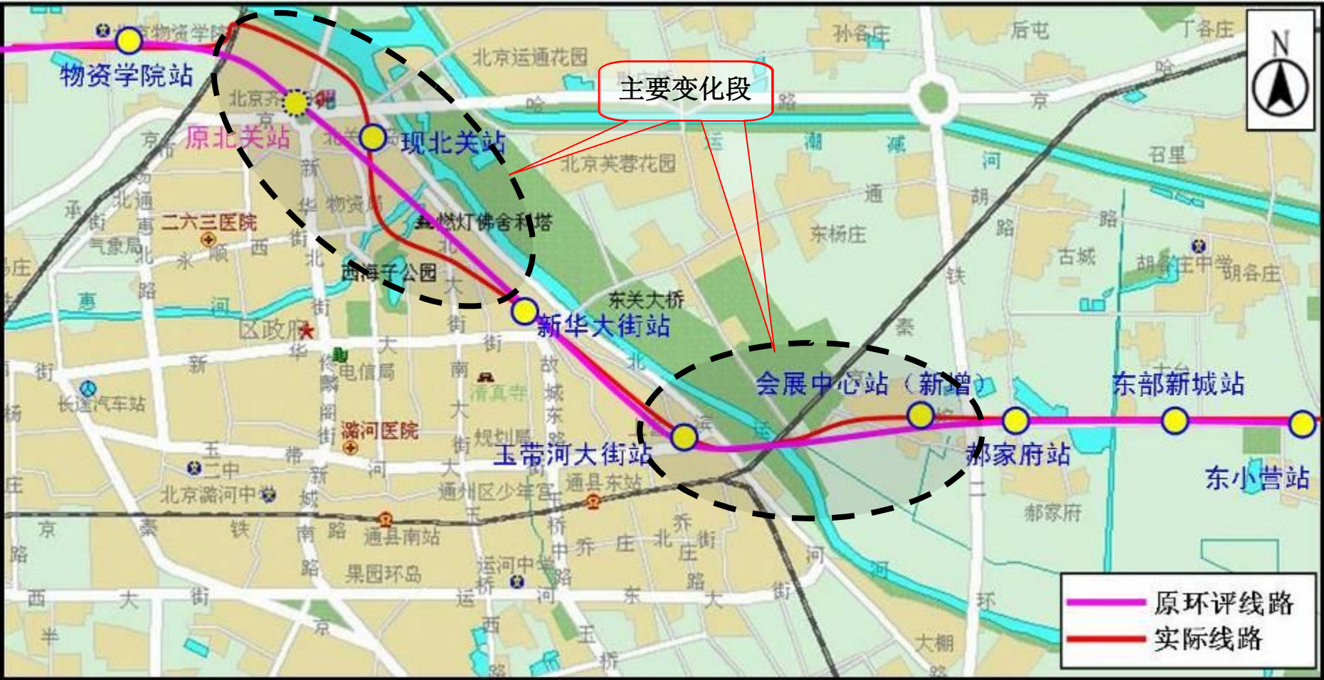
图 2.2-1-1 工程变更前后线路走向及车站对比示意图
