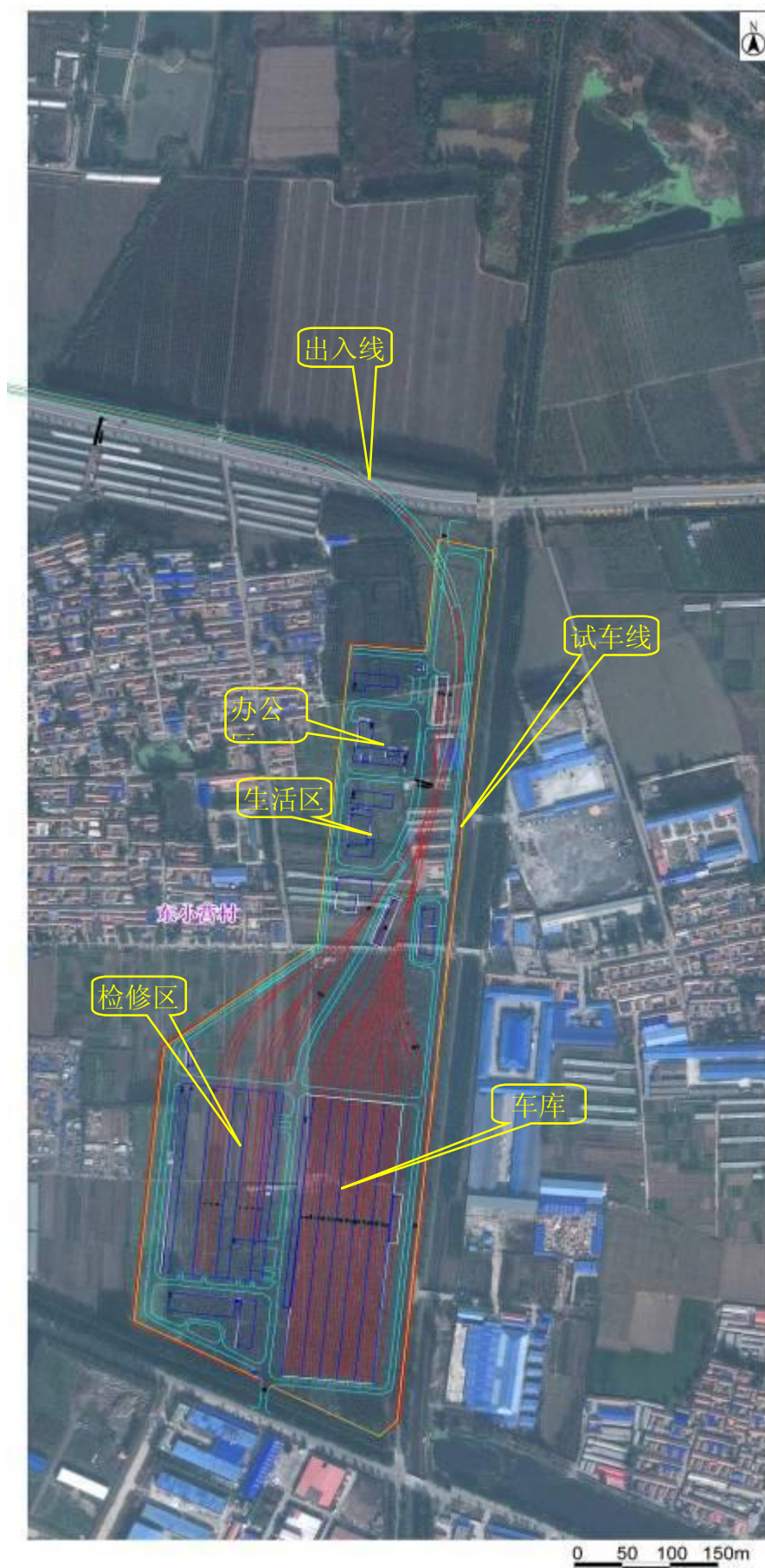
图 2.2-5 变更后东小营车辆段平面布置图
